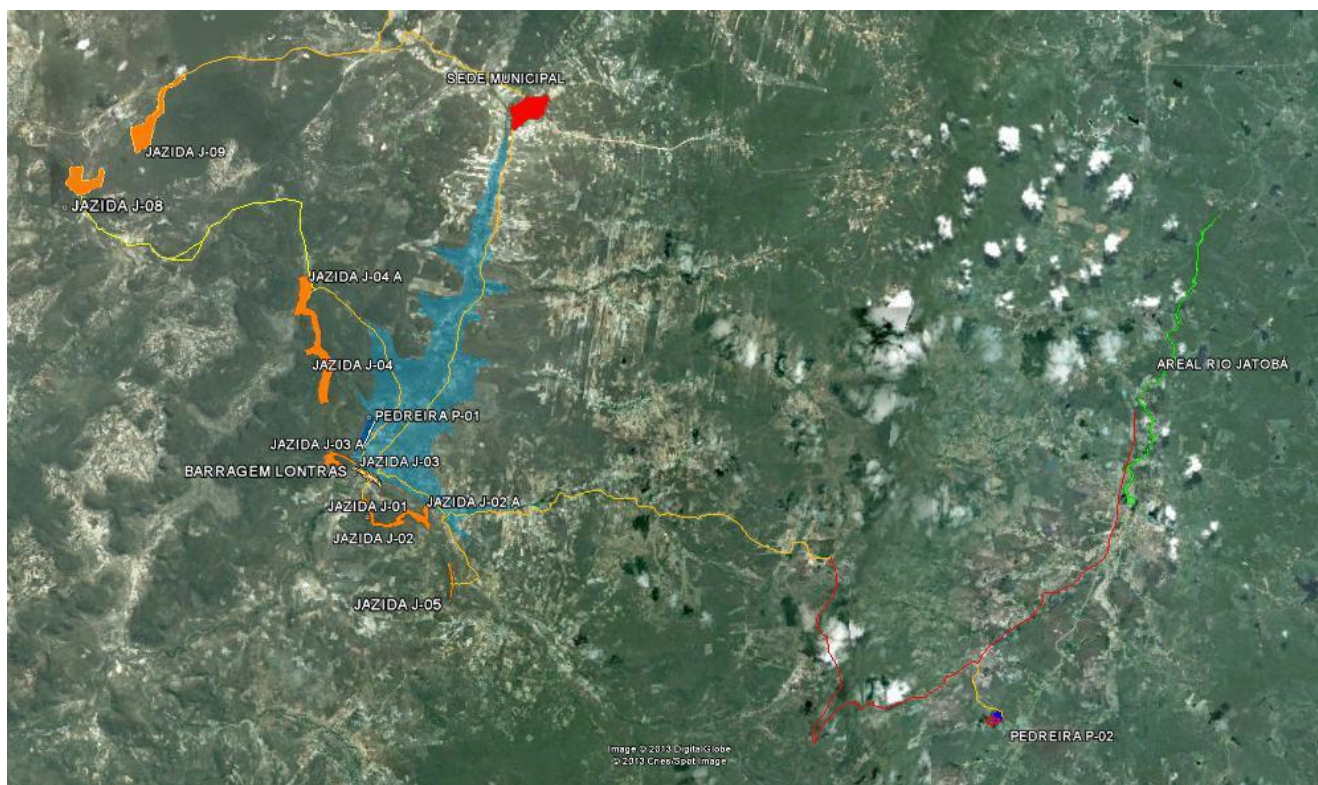
Figura 4.3.7 - Localização das jazidas em estudo para utilização no maciço da barragem Lontras
