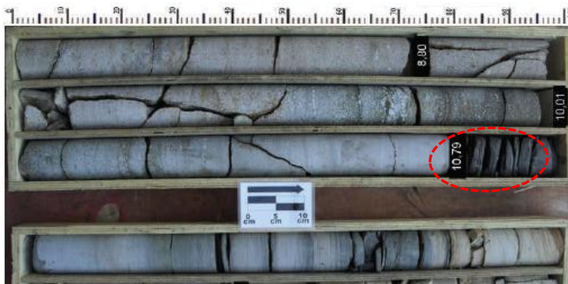
Foto 4.3.10 – Trecho da sondagem SMB-04, com foco de 10,79 a 11,00 m, onde aparenta existir uma junta de alívio, caracterizada pelo aspecto discoide dos fragmentos rochosos.
