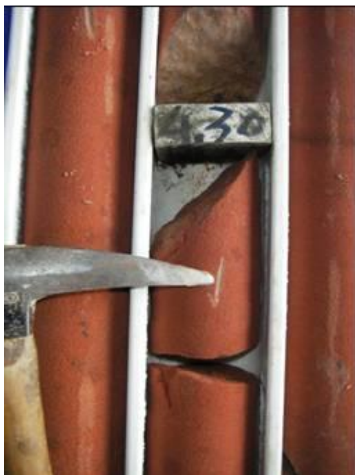
Foto 4.3.8 - Arenito medianamente coerente (C2). O risco da ponta do martelo produz um sulco leve.
