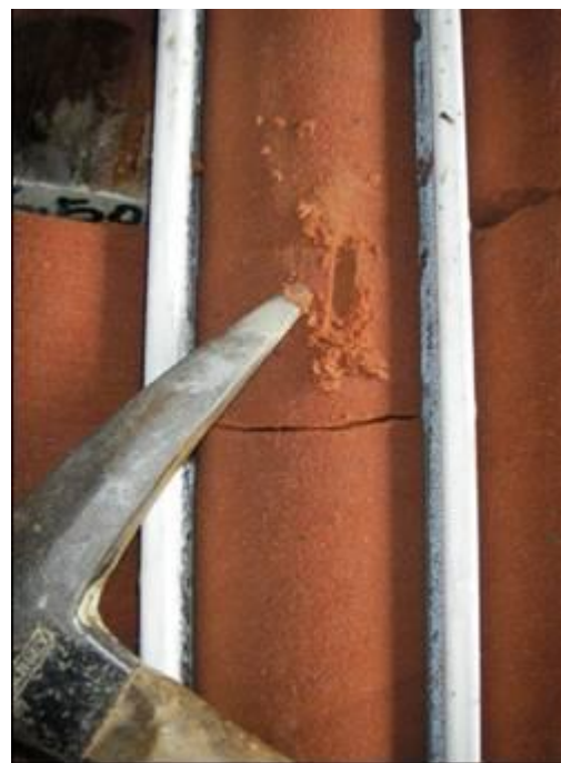
Foto 4.3.9 - Arenito pouco coerente (C3). O risco da ponta do martelo produz um sulco profundo.
