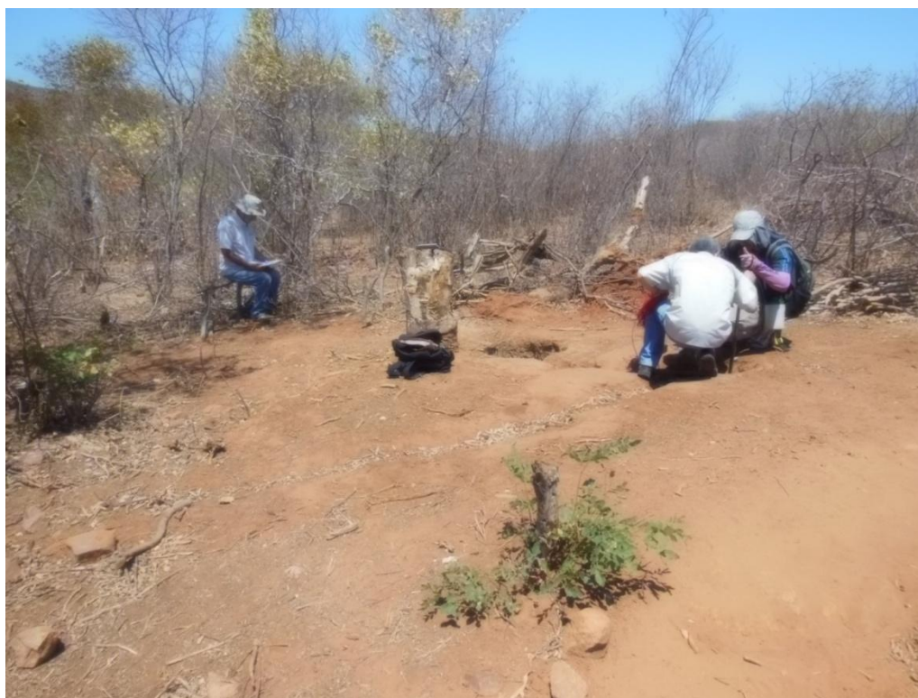
Foto 4.3.6 – Medição de nível d'água no furo da SMB-09, na ombreira direita, estaca 12+00, onde foi encontrada a ocorrência de rocha ígnea extrusiva, provavelmente diabásio.
